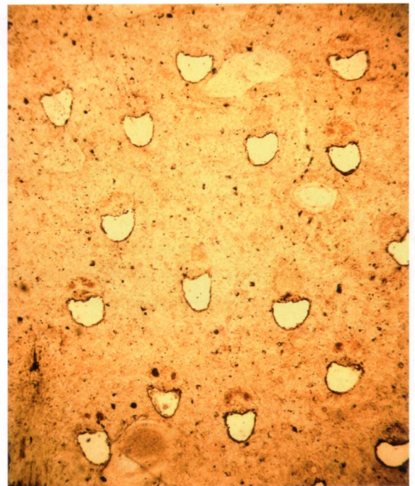
Afbeelding 4. Slijpplaatje van slecht geconserveerd palmhout met de karakteristieke doorsnede van de buisjes. Schoonebeek. Breedte foto 4,5 mm. Palmhout coll. F. Rhebergen, slijp- plaatje 379 coll. J. van der Burgh.
