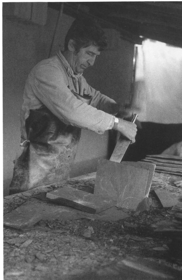
Afb. J - 3. Het splijten van leisteen op de gewenste dikte.
