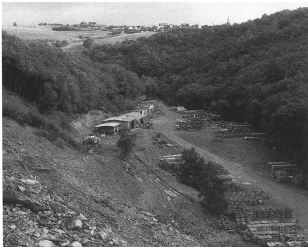
Afb. J - 1. Deel van de leisteengroeve Eschenbach I met rechts- onder kratten geïmporteerde Spaanse leien. Dichter bij de loodsen staan kratten bewerkte leien, klaar voor transport. Op de achtergrond het plaatsje Bundenbach.
