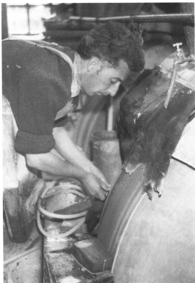
Afb. 5. Beeld uit de historische Weihereschleife: slijper, liggend voor de door waterkracht aangedreven slijpsteen.
