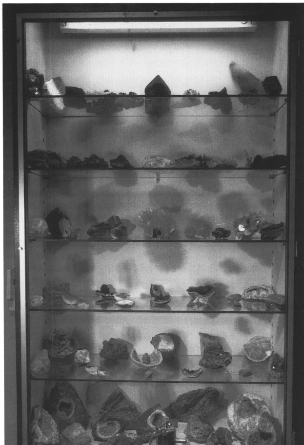
Afb. 3. Vitrinekast met glazen legplaten. De glasruit is gevat in een aluminium lijst. Een van de TL-verlichtingsbalken is nog net zichtbaar.
