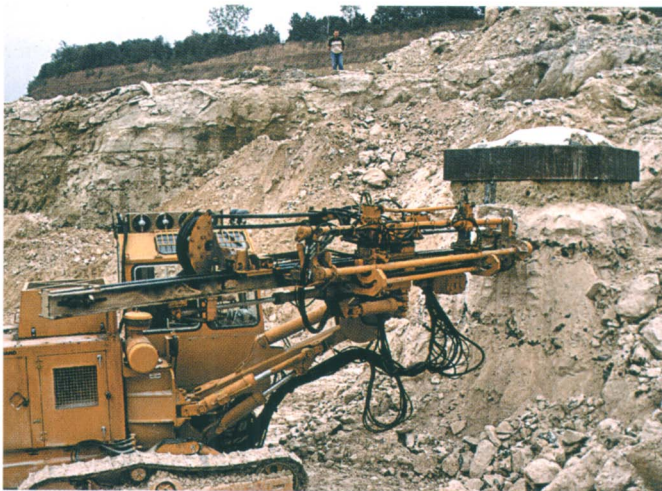
Afb. 5. Met de enorme verrijdbare boormachine van de ENCI wordt de schedel, die goed ingepakt zit in een staal- en betonnen kraag, ruim een meter onder het fossiel losgeboord, als ging het om een postzegelperforatie.
