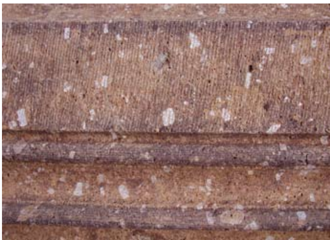
Afb. 2. Detail van de Reimerath-trachiet met duidelijk zichtbare, centimeter-grote fenokristen van sanidien (Foto R.P.J. van Hees).
