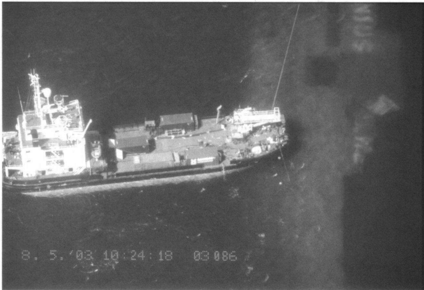
The multipurpose offshore salvage and diving support vessel Union beaver is specially equipped to clean up oil from the sea. Het multifunctionele offshore bergingsvaartuig Union beaver is speciaal uitgerust om olie van het zeeoppervlak op te ruimen (photo MUMM).
