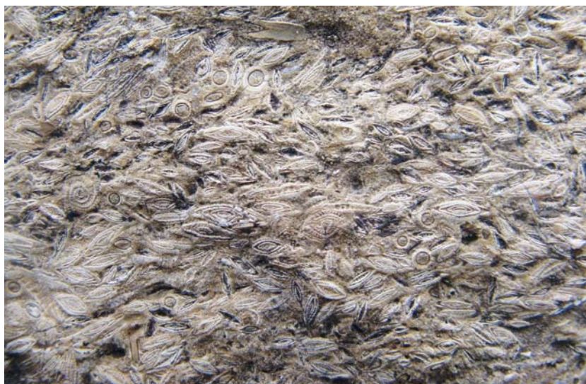
AFBEELDING 7. | Detail van een opeenstapeling van Nummulites planulatus in Ieperiaanse steen. Ook zijn enkele cirkelvormige doorsneden van Ditrupa wormkokers zichtbaar, Onze-Lieve-Vrouw Geboortekerk te Wortegem.
