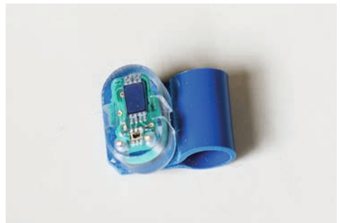
Een geocator die om de poot van een vogel kan worden aangebracht. Foto: Ilse Hooijmeijer.
