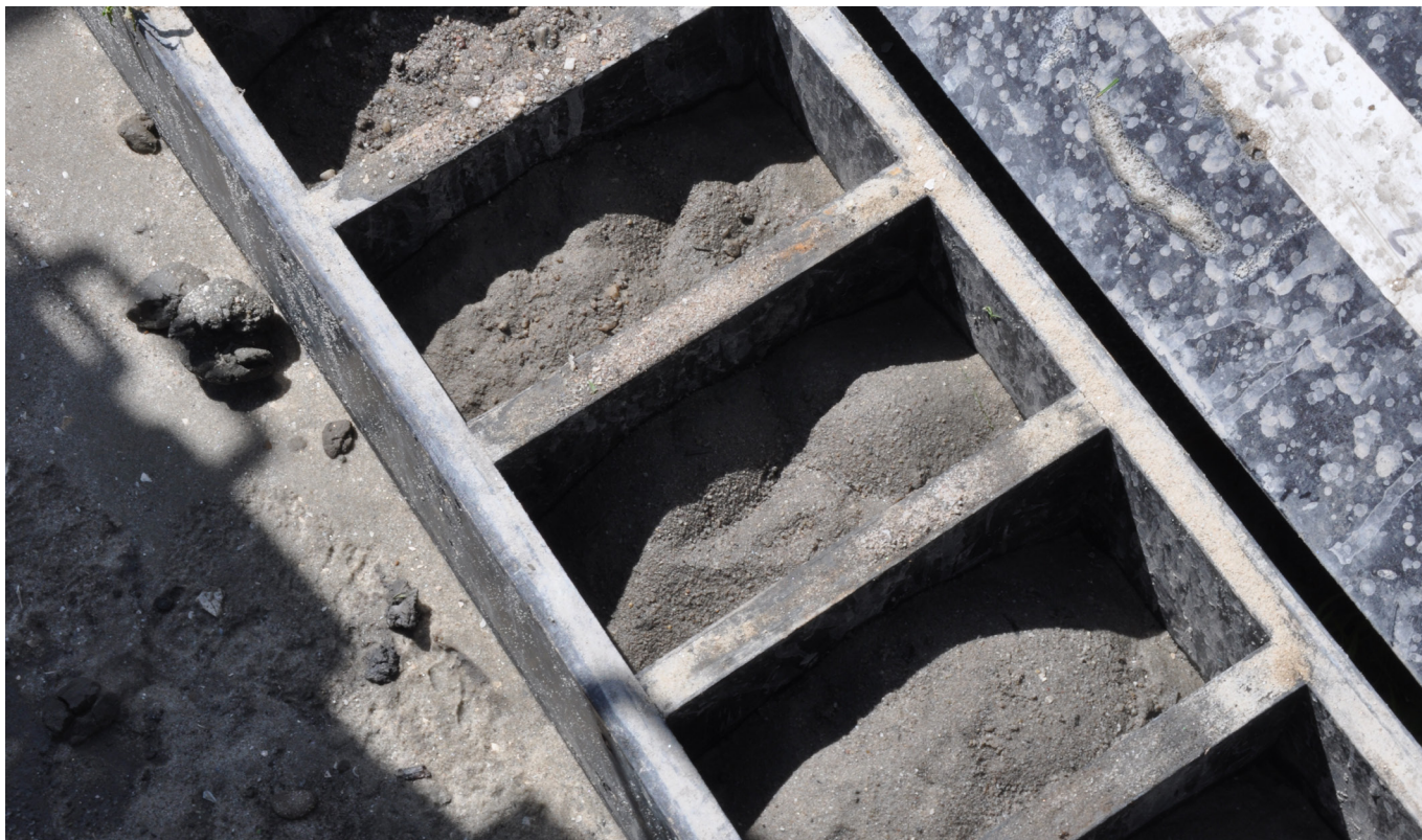
▲ Van elke meter wordt er een klein monster sediment genomen voor geologische analyse. (Bram Langeveld)
