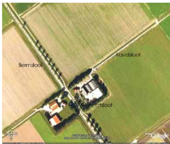
Figuur 1. Illustratie van een kavelsloot, erfsloot en een berm-sloot.
