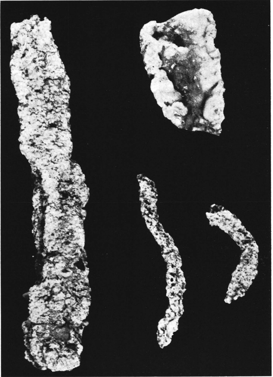
Afb. 3. Bliksembuisfragmentjes uit een zandgraverij te Westerhaar. De glasachtig gesmolten binnenzijde is op het stukje rechts boven duidelijk te zien. 2 × vergroot.
