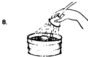
Monsterbewassing door een aantal zeven met een waterstraal
