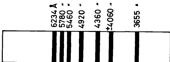
Fig. 5: Zo ziet een kwikspektrum er uit in een spektroskoop met daarbij de verschillende golflengten in Å. Eén Å (Angström) is 1/10.000.000 mm.
