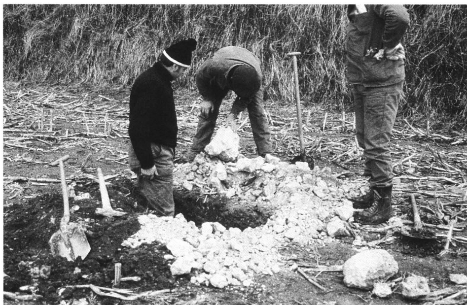
Fig. 1 Proefput voor het verkennen van de Kunrader kalksteen (Formatie van Maastricht) in de omgeving van Wyhre. Foto P.W. Bosch, 1973.
