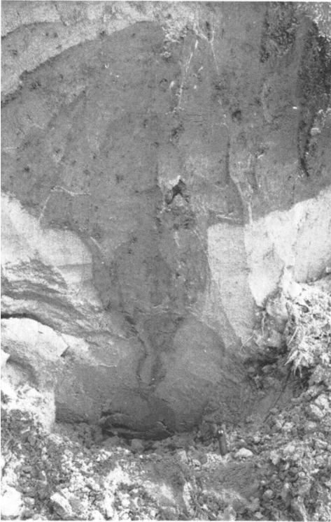
Fig. 4: Met keileem opgevulde vorstwig aan de basis van het keileem ontsloten bij Klazienaveen. Onder het keileem fijnzandige afzettingen vermoedelijk behorende tot de Elsterien Peelo Formatie. Aansteker geeft schaal. Deze plek is hierdoor ongeschikt voor steenoriëntatiemetingen.
