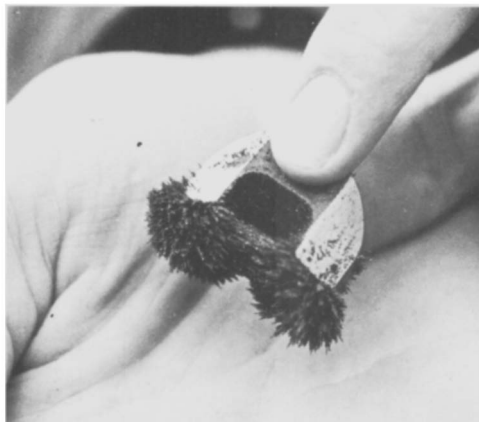
Fig. 3 Magneet met plukken magnetisch zwaar zand uit Nieuw-Zeeland. (Foto: Pieter van der Klugt).
