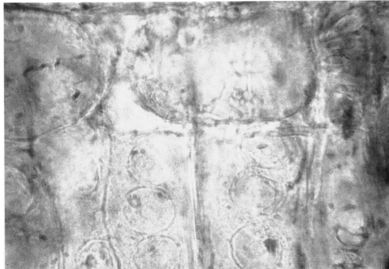
Afbeelding 3. Aangetaste eipoor (bovenaan) in een slijpplaatje. Onderaan zijn houtvaten met uniseriale hofstippels te zien. (Gefotografeerd door microscoop met 100x objectief en Nikon coolpix 4500 met microscoopadapter door oculairhouder).
