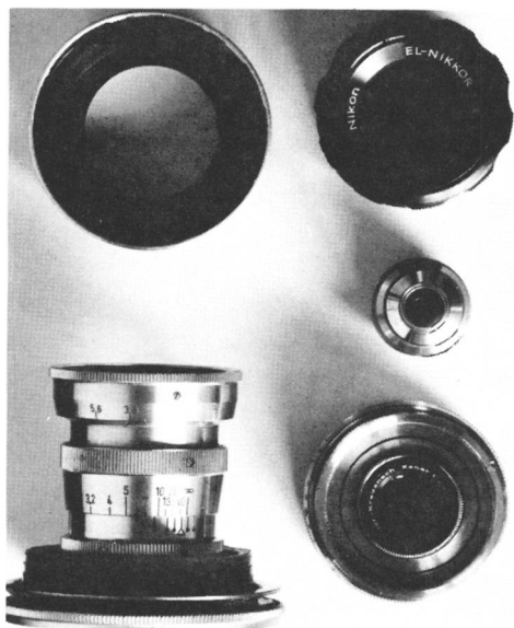
foto 5. Makroring, waarin schroefdraad voor drie lenzen. De zonnekap wordt op de El Nikkor gedraaid en op de donkere ring geschoven die op de makroring zit. De El Nikkor zit dan altijd in de Retrostand.
