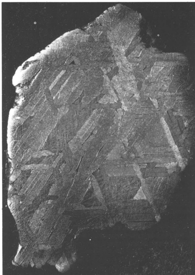
Afb. 1. IJzermeteoriet, aangeslepen, gepolijst en geëtst. Afmeting: 72 x 50 mm. Herkomst: Toluca, Mexico. Collectie: H. van Denebroek.
