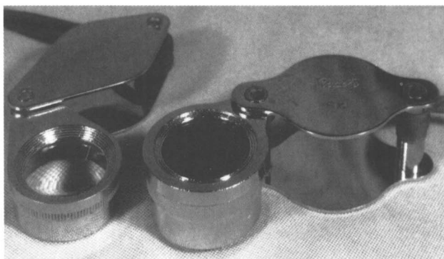
Afb. 3. Inslagloepen. Rechts: het lenzenblok is 19 mm hoog; links: de hoogte is 12 mm. Beide loepen hebben een vergrotingsfactor van 8x, maar het rechter exemplaar is het beste.
