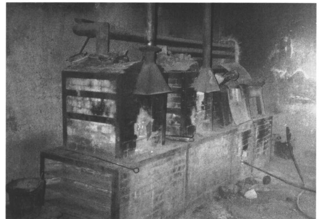
Afb. G - 5. Ouderwetse smeltovens voor ertsmonsters in het laboratorium van de goud/zilvermijn van Jales. Op bijna Middeleeuwse wijze wordt in Jales voor de analyse een kleine hoeveelheid erts vermalen. Via een aantal smeltgangern blijft uiteindelijk één goud-zilverkorreltje over. De rijkelijk aanwezige zwavel komt hierbij zonder "problemen" via de schoorsteen in de lucht terecht.
