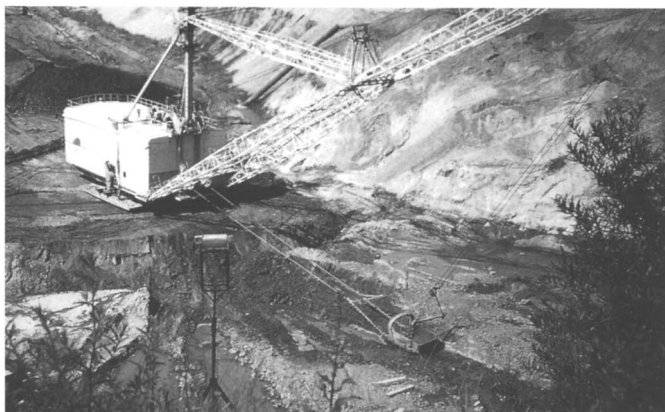
Afb. 4. De mijn Primorskoye in Jantarnyi, Rusland. Op de voorgrond wordt materiaal afgegraven en achter de machine (links boven) gedeponeed. Vandaar gaat het naar de "wasserijs".
