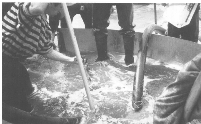
Afb. 1. Hydromechanische winning van barnsteen: twee boren en twee slangen, afgeschermd met metaalplaten. De man links kijkt of ze op de juiste diepte zitten, waar voldoende barnsteen is.
