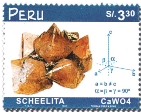
Afb. 7. Postzegel uit Peru met de typische kristallen, de formule en de kristallografische assen van Scheeliet.
