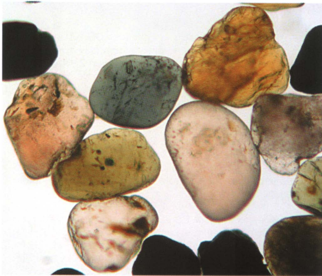
Afb. 7. Zand met macroscoop spectaculair vergroot. Manueel ingesteld op het blauwe mineraal. Geen diafragma gebruikt, omdat dat met een oculair niet gaat. Het scherptevlak ligt loodrecht op de optische as.
