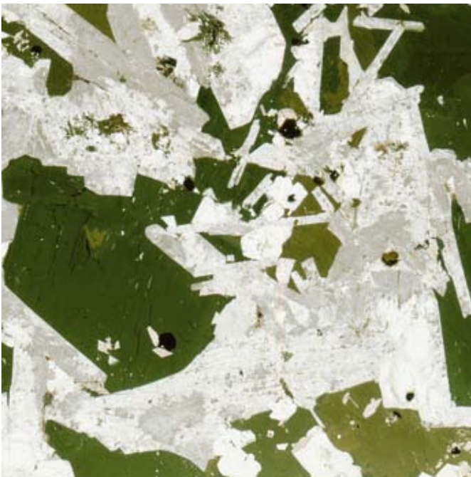
Afb. 14. Groene foyaiet. Dit slijpplaatje laat de vergroeiing zien van alkali-veldspaat (lichtgrijs) en aegirien (groen) Zo'n vergroeiing betekent dat de mineralen ongeveer gelijktijdig zijn uitgekristalliseerd.
