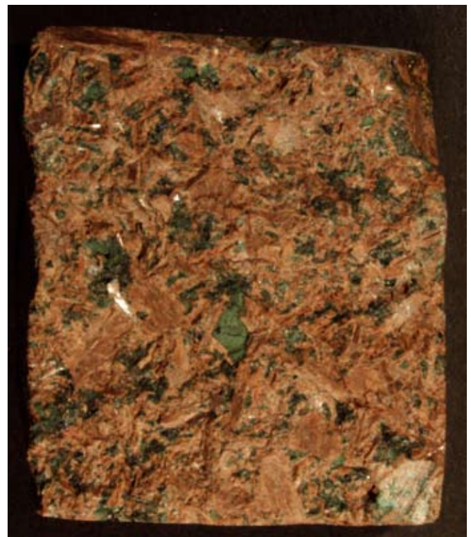
Afb. 12. Dit is een rode syeniet met een vers breukvlak. Het rode materiaal is alkaliveldspaat dat door insluitels van ijzeroxiden rood gekleurd is. De groene korrels zijn aegiriënaugiet, een natriumhoudende pyroxeen. Beeldhoogte 45 mm.
