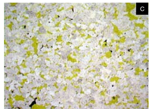
Afb. 21. Microfoto's van zandstenen gebruikt aan de Pieterskerk, in parallel gepolariseerd licht (beeldveld 5,4 x 3,5 mm): A. Bentheimer, B. Obernkirchener, C. Rakowicze.
