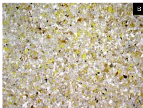
Afb. 21. Microfoto's van zandstenen gebruikt aan de Pieterskerk, in parallel gepolariseerd licht (beeldveld 5,4 x 3,5 mm): A. Bentheimer, B. Obernkirchener, C. Rakowicze.
