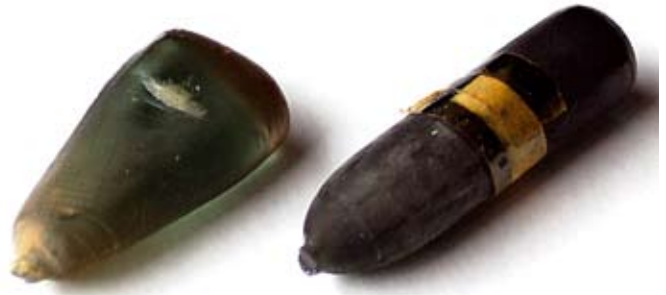
Afb. 4. Twee smeltperen volgens de Verneuil-methode. Links: spinel; rechts: korund.
