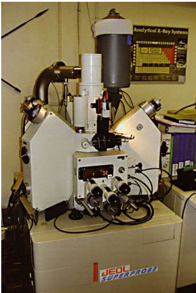
Afb. 1. De JEOL Ltd. JXA 8800M – Superprobe van het Laboratorium Microanalyse van de Vrije Universiteit Amsterdam.
