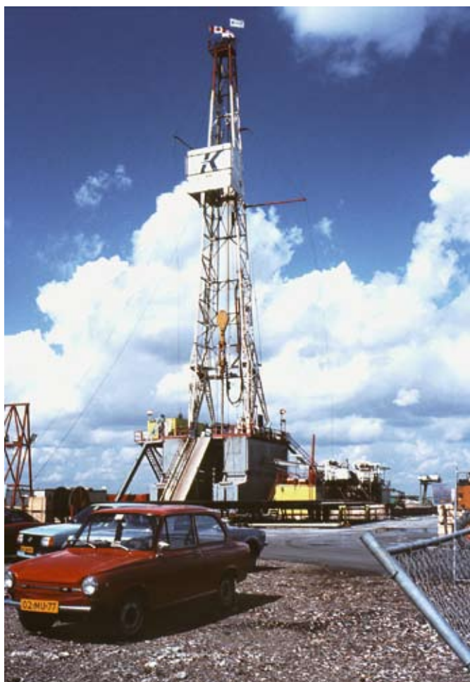
Afb. 3. Boortoren Kenting N80 UE in augustus 1982 bezig met de boring Blaricum-1 in opdracht van Petroland B.V. De plaats van de boring was gelegen in een polder langs het Eemmeer. In de jaren voorafgaand aan de boring werd in het hele Gooi seismisch onderzoek gedaan om de diepere ondergrond in kaart te brengen. De gevonden gegevens gaven aanleiding voor een exploratieboring naar het voorkomen van aardgas. Voor zover bekend is er geen winbare hoeveelheid aardgas gevonden.
