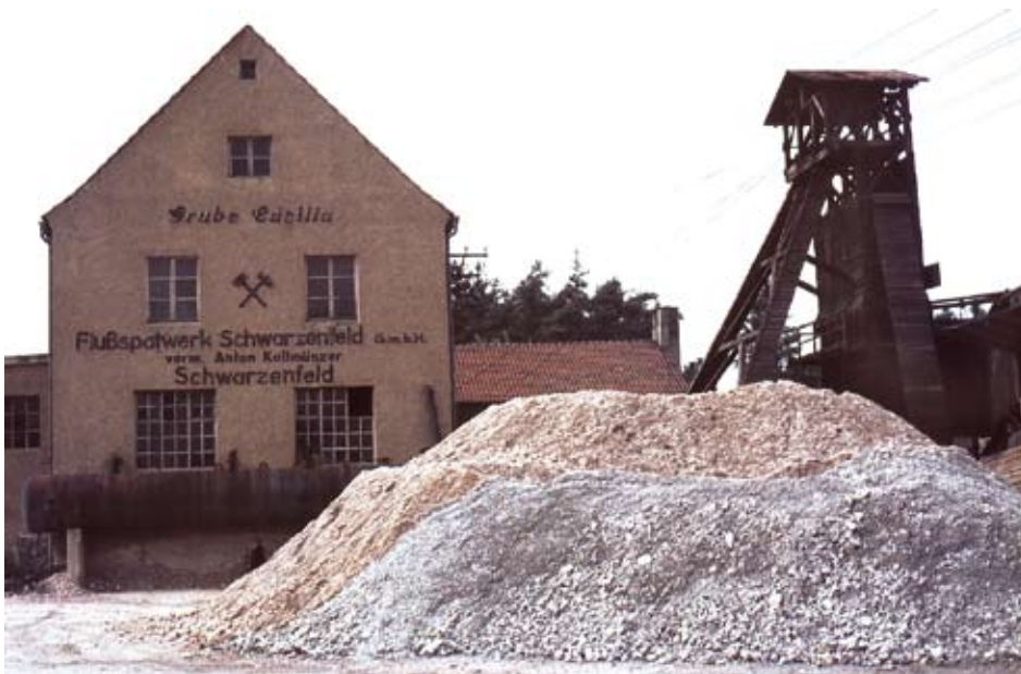
Afb. 6. Gebouw en schachttoren van de fluorietgroeve Cäcilia bij het dorpje Stulln nabij Wölsendorf (Oberpfalz, Beieren, Duitsland). De winning van fluoriet (vooral voor gebruik bij hoogovens als vloeimiddel bij het smelten van ijzer) in dit district begon aan het einde van de 19 e eeuw, en is definitief gestopt in 1987. In de jaren 1950-1960 werd er uit meer dan 30 groeves 10% van de wereldproductie geleverd, in totaal 2,5 miljoen ton fluoriet. De groeve Cäcilia was in de jaren 1950 met 180 ton fluoriet per dag de grootste fluorietmijn ter wereld, maar is in 1973 gesloten. In 1963 is de mijn beroemd geworden door de vondst van merkwaardig gevormde fluorietkristallen. De kristallen hadden langgerekte, op een skalenoëder lijkende vorm. De schachttoren op de foto dateert van 1933, de twee stapels fluoriet op de voorgrond zijn geen plaatselijke productie, maar ingevoerd uit Frankrijk. Gefotografeerd in augustus 1973 enkele maanden voor de definitieve sluiting.
