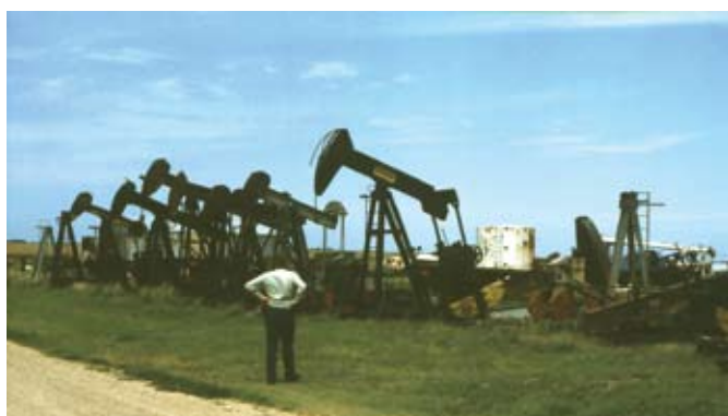
Afb. 4. Jaknikkers in Russell County, Kansas, USA, wachtend op hun inzet. Een jaknikker is de populaire benaming voor het bovengrondse deel van een pomp die aardolie uit de grond oppompt. Nadat met behulp van een boortoren een oliebron is aangeboord, wordt de leiding naar de bron aangesloten op een dompelpomp . Deze pomp bevindt zich diep onder de grond, in de op te pompen olie. De pomp wordt aangedreven door een bovengronds geplaatste elektromotor . De jaknikker verzorgt de mechanische overbrenging naar de zuiger in de ondergrondse pomp. Opname: juli 1997.
