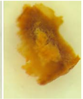
Afb. 15. Residu dat overblijft van het fragmentje na reactie met zoutzuur.
