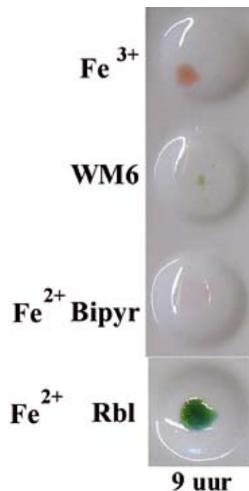
Afb. 18. WM6: Na 9 uur is er nog steeds \text{Fe}^{2+} aanwezig.
