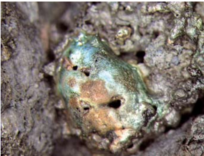
Afb. 7. Groen kobaltzinkaaf laat zien dat zink aanwezig is.
