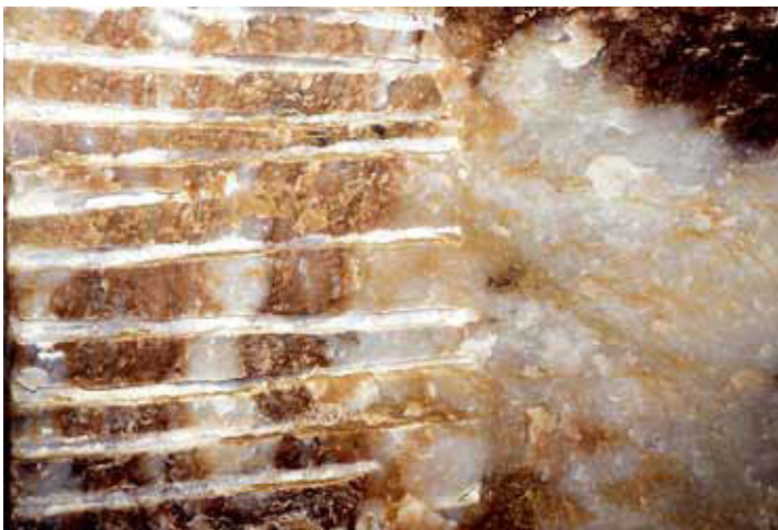
Afb. 5. Albast in de ondergrondse groeve van Fauld Mine. Het laatste hier gewonnen blok albast werd in 1996 gekocht door Steenhouwerij Maarssen in Nederland. De diameter van de boorgaten bedraagt ca 3 cm.
