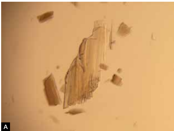
Afb. 4a. Vergruizelde Boutaresse kristalfragmenten in gepolariseerd licht. Alleen de polarisator is ingeschakeld. Indien ook de analysator wordt ingeschakeld ligt het centrale fragment (lengte 0,3 mm) in uitdovingspositie. De uitdovingshoek t.o.v. de lange as van het fragment is ongeveer 5°.
