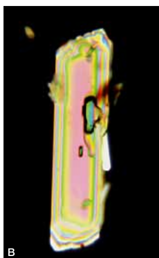
Afb. 6a. Eén van de groene fragmenten (lengte 0,3 mm) waarvan de brekingsindex bepaald werd. De kleinste brekingsindex is 1,69 ( \alpha of \alpha' ) de grootste is 1,73. Deze waarden liggen binnen de grenzen van bijvoorbeeld augiet maar ook van CaNa-amfibolen als hoornblende. Groene hoornblende kan in vulkanieten af en toe voorkomen. De bepaling van de uitdovingshoek moet dan uitsluitend geven.
