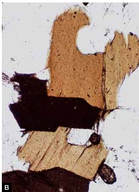
Afb. 2. Slijplaatje met biotiet; 0-W is richting van polarisator. A. Biotiet is donker in 0-W-oriëntatie. B. Biotiet is licht in N-Z-oriëntatie (90° gedraaid).
