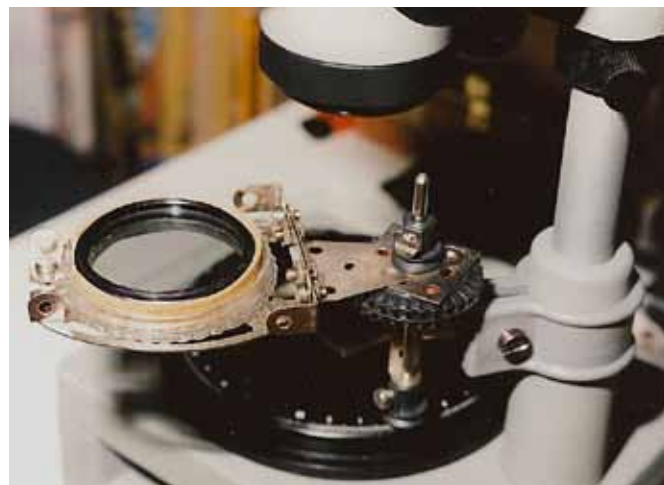
Afb. 3. Uitklapbare analysator bij MBS10-microscoop. De polarisator zit onder de draaitafel.
