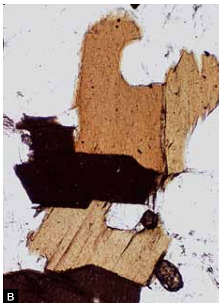
Afb. 2. Slijpplaatje met biotiet; 0-W is richting van polarisator. A. Biotiet is donker in 0-W-oriëntatie. B. Biotiet is licht in N-Z-oriëntatie (90° gedraaid).
