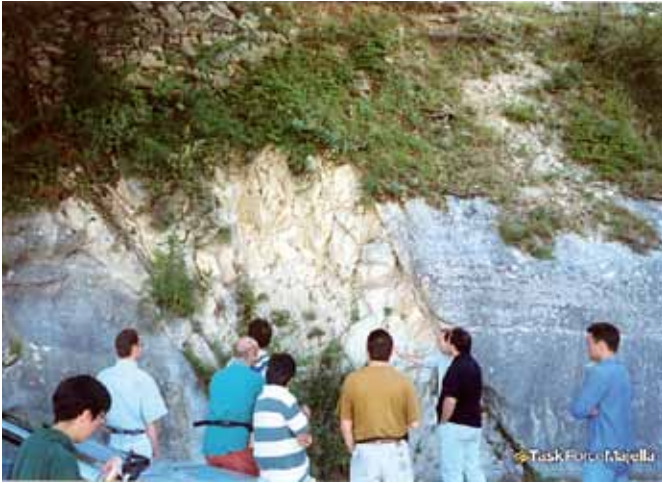
Afb. 10. Een breukvlak in Paleogene calcarenieten in de buurt van Pen-napiedimonte. Het breukvlak helt steil naar het noorden en is opgebouwd uit een sterk verbreukte massa van gesteente met een dikte van enkele meters. Het is goed te zien dat links en rechts van de breuk de deformatie van het gesteente abrupt ophoudt en geen spoor van vervorming waar te nemen is. Voor geïnteresseerden: De sedimentaire bedding helt circa 60° naar ons toe, en de breuk heeft een verzet van enkele tientallen meters. De classificatie en gedetailleerde beschrijving van dit soort fenomenen is één van de hoofdonderwerpen van de TaskForceMajella omdat de structuur van het verbreukte gesteente de vloeijing van olie, gas, en water sterk bepaalt. Foto: Collectie J.P. van Dijk (derde van rechts), 1998.
