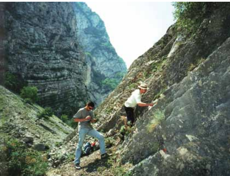
Afb. 6. Metingen in de Valle Santo Spirito in de buurt van Fara San Martino. Leonardo Marchegiani (Camerino Universiteit, links) en Paul Gillespie (NorskHydro) verrichten hier geomechanische metingen. De micritische (=fijnkorrelige) kalkgesteentes uit het Krijt hellen hier steil naar het oosten en maken deel uit van de 'externe' flank van de Majella-anticline. We kijken in de richting van de zee, naar het zuidoosten. Foto: J.P. van Dijk, 2001.
