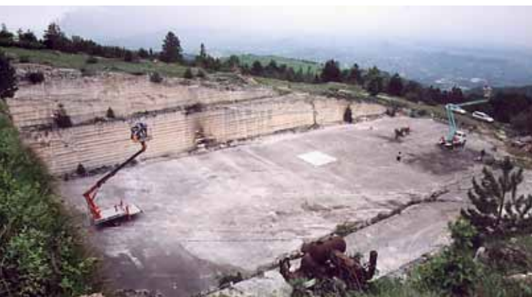
Afb. 4. Werkzaamheden in de Madonna della Mazza-groeve. Deze oude steengroeve met zogeheten 'chalk' (een zeer poreuze soort kalkgesteente) uit het Boven-Krijt, is gesitueerd aan de oostelijke (zee-) zijde van de Majella en biedt allerlei mogelijkheden breuk- en fractuurpatronen te bestuderen. Voor de TaskForceMajella zijn er daarom uitgebreide werkzaamheden verricht. Vanuit de heftrucks worden stereofoto's gemaakt in hoge resolutie waarmee een driedimensionaal model van het gesteente kan worden samengesteld. Foto (in noordelijke richting): J.P. van Dijk, 2003.
