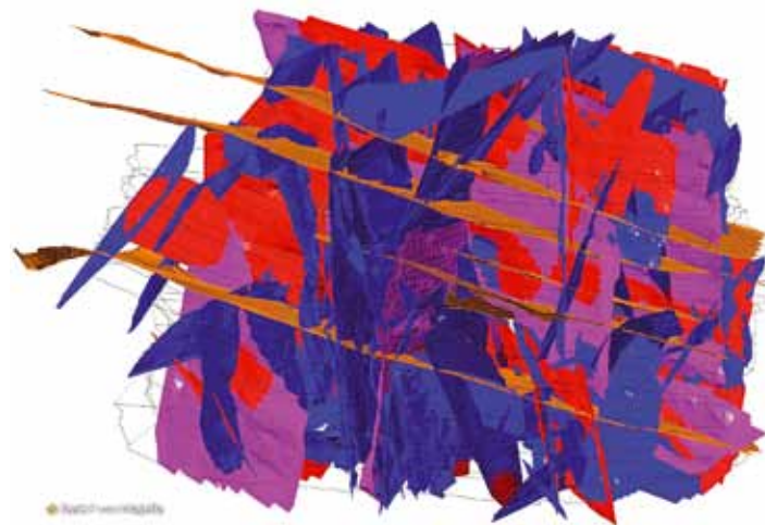
Afb. 9. 'Deterministisch' computermodel van een breuk- en fractuurnetwerk (ca 1 m 3 groot) dat de werkelijke breuk- en fractuurvlakken in het gesteente representeert (in tegenstelling tot 'stochastische' of 'probabilistische' modellen waarin de uitkomst niet vastligt). Met behulp van dit soort modellen kan het transport van vloeistoffen en gassen in gesteente worden berekend en voorspeld. In beige: de sedimentaire gelaagdheid; rood: open fracturen; paars: gereactiveerde fracturen; blauw: gesloten fracturen. Bron: Raffaele Di Bella (Rome 1 La Sapienza Universiteit) i.s.m. J.P. van Dijk (Eni), 2005.
