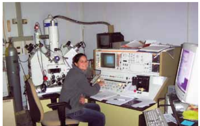
Afb. 3. Electron microprobe analyser en bijbehorende apparatuur (foto Hebrew University of Jerusalem).
