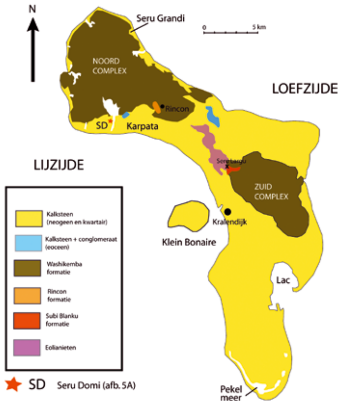
Afb. 3. Vereenvoudigde geologische kaart van Bonaire. Het grootste deel van het eiland bestaat uit Neogene en Kwartaire kalksteen. De oudste gesteenten worden gevormd door andesitische en (rhyo-)dacitische afzettingen uit het Krijt (tussen Albien en Coniacien). De vulkanische formatie (BWF, de Bonaire Washikemba Formatie) bestaat uit een Noord-Complex dat het heuvelland omvat en een Zuid-Complex, een gebied ten oosten van Kralendijk. Verder heel lokaal de Rincon Formatie, een uit kalksteen en conglomeren bestaande afzetting uit het Laat-Krijt (Maastrichtien) (Mac Gillavry e.a. 1977), en langs de weg van Kralendijk naar Rincon, bij Subi Blancu, ligt een fluviaatiele afzetting van conglomeren, zandsteen en kleisteen: de Subi Blanco Formatie. In deze afzetting uit het Eoceen zijn granodiorieten, aplieten, gneis, schisten, kwartsieten en amfibolieten in de vorm van rolstenen gevonden die geologisch 'vreemd' zijn voor Bonaire. Deze Subi Blanco Formatie met de rolstenen zou gevormd zijn in een periode dat Bonaire met het vasteland van Zuid-Amerika verbonden was. Bovenop de heuvelrug vanaf de Seru Largu naar Montagne ligt een kalksteenafzetting zonder de macrofossielen (koralen) die men in de terraskalken vindt. Deze versteende duinafzettingen (eolianieten) komen op alle drie de eilanden voor. Lijzijde: De NO-passaat waait hier vanaf het land richting zee. Aan deze kant van het eiland is de zee kalm en is er nauwelijks branding. Loefzijde: De wind waait hier vanuit de zee naar het land, de zee is hier wild met een flinke branding. (Kaart getekend naar Pijpers (1933), De Buissonjé (1974) en Beets e.a. 1977).
