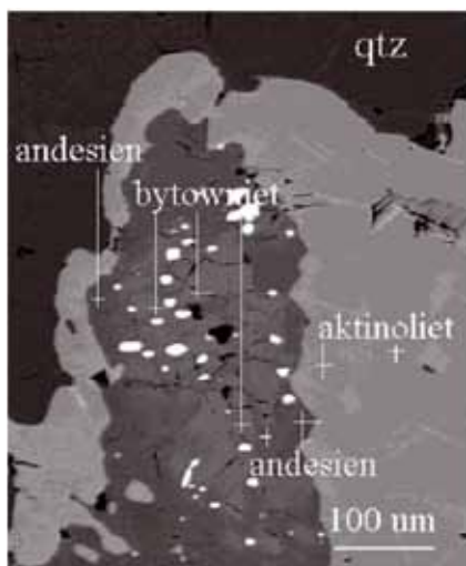
Afb. 7b. EMP-afbeelding van een type 3 Ca-amfibool (grijs) in een kelyfitische rand om granaat samen met plagioklaas (donkergrijs). De amfibolen zijn vanaf de granaatrand: magnesio-hastingsiet en edeniet. De plagioklazen zijn type 1 en zijn vanaf de granaatrand: bytowniet (donkergrijs), labradoriet (nog donkerder grijs) en andesien (nog donkerder grijs). Locatie omlijning 3 in afb. 2.
