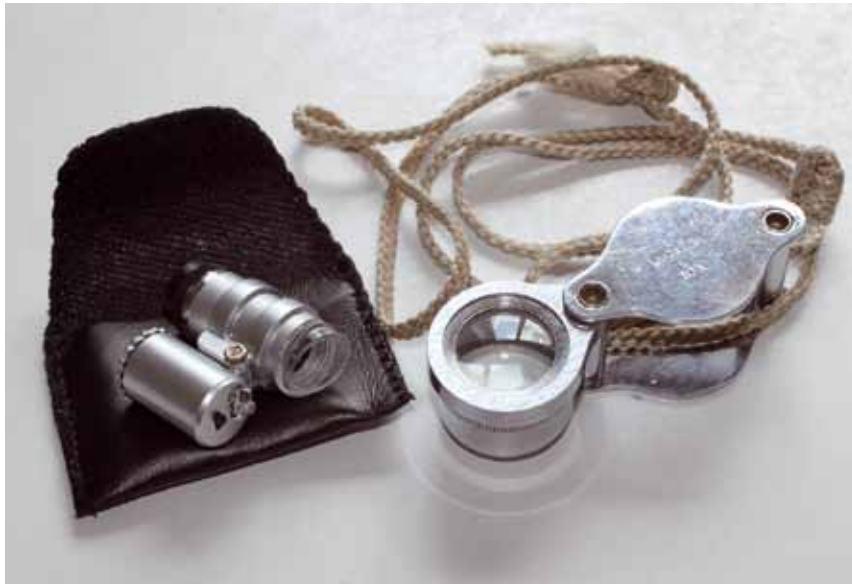
Afb. 1. Links de mini-microscoop op zijn hoesje, rechts de al meer dan 30 jaar in gebruik zijnde inslagloep.
