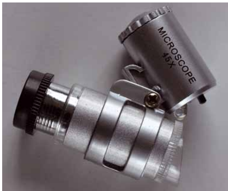
Afb. 2. Zijaanzicht van de mini-microscoop. Het batterijhuis met de leds kan gekanteld worden teneinde het licht zo goed mogelijk op het object te richten. Let op de schuine rand.
