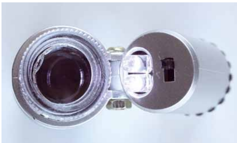
Afb. 3. De onderkant van de mini-microscop, Links de lens en rechts het batterijhuis met schakelaar en brandende leds.
