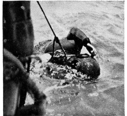
Fig. 2. De duiker komt in zijn opgeblazen duikerpak boven drijven. Hij heeft de hand aan de reguleteur van de luchtafvoer aan de helm.
