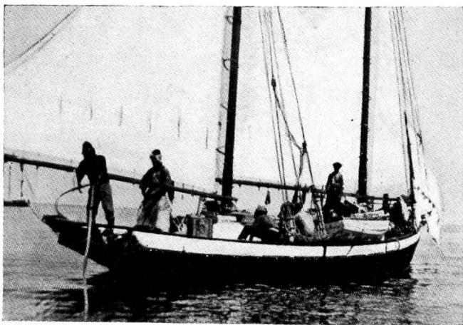
Fig. 1. Parelschoener aan het werk. Duidelijk ziet men den helper met de luchtslang en ook de „tender” met de z. g. lifeline. Hij heeft het leven van den duiker in de hand.
