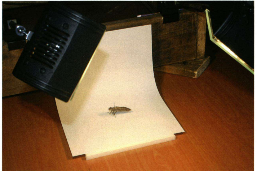
Een opstelling voor het fotograferen van larvenhuidjes in niet-natuurlijke omgeving met halogeenlampen.
