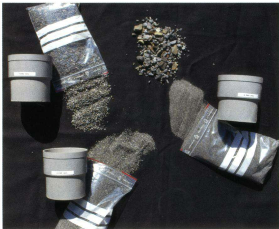
Afbeelding 3. Zandfracties na het zeven: linksboven zee fractie 1,940 mm; linksonder zee fractie 0,930 mm; rechts zee fractie 0,466 mm.
