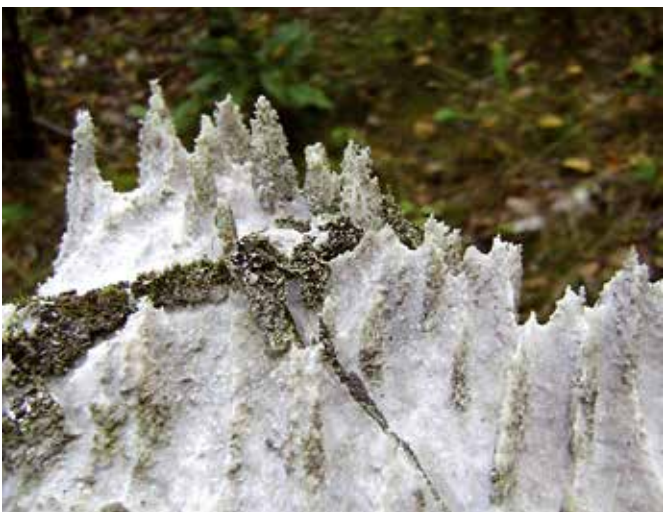
Afb. 1. Corrosie van gips op een los blok in een steengroeve in de Harz. Deze formaties van enkele decennia oud laten zien hoe snel dat proces verloopt. De uitstekende punten zijn enkele centimeters lang.
