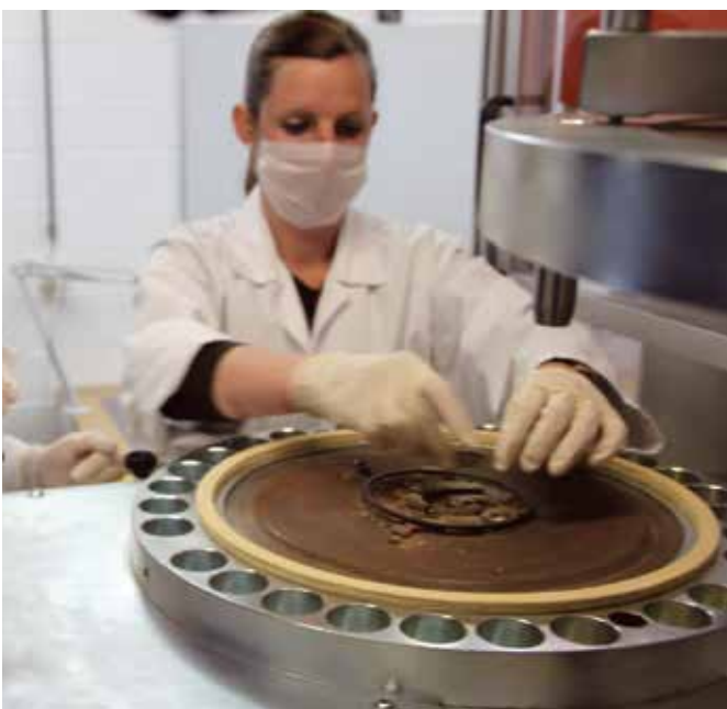
Afb. 4. Apparatuur met groeicellen waarin de koolstof uit de as verder wordt gezuiverd.
