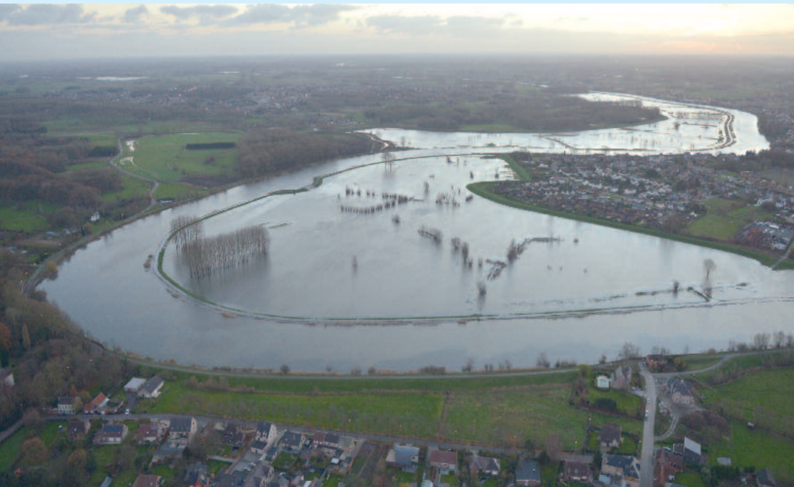
Foto A. Overstromingsgebieden Bergenmeersen (voorground) en Paardeweide (achtergrond) in werking tijdens stormtij (Flanders Hydraulics Research, Hydrological Information Center).
