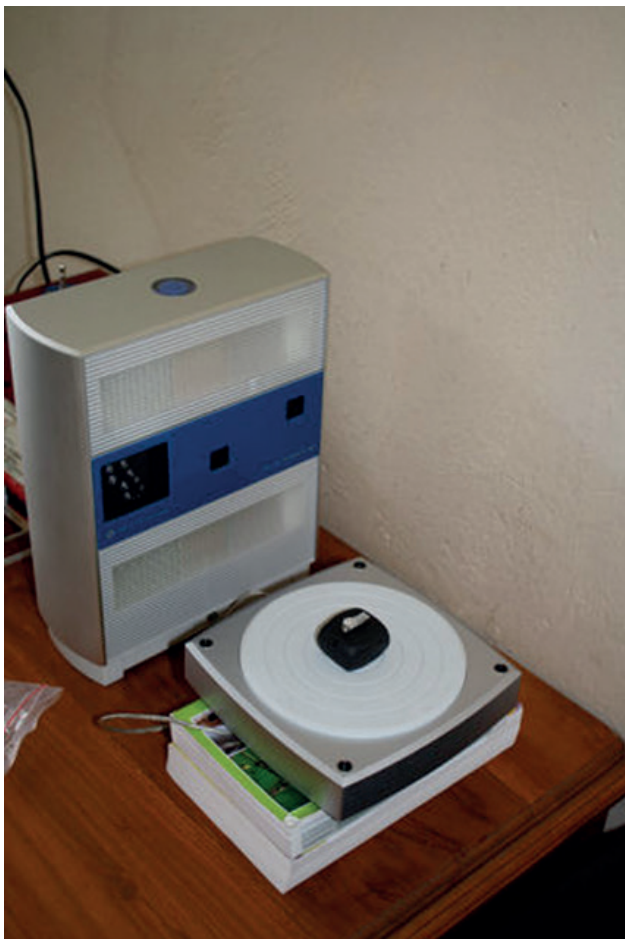
Een mobiele laserscanner in actie. Dit model is relatief goedkoop en wordt veel gebruikt in veldwerk situaties vanwege de kleine afmetingen. Op het draaiplateau ligt een fossiel teenkootje van een roofvogel
