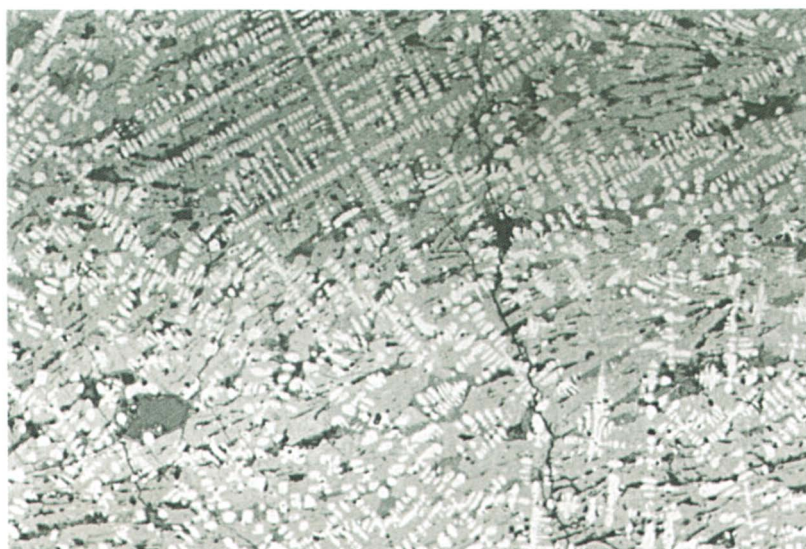
Afb. 11. Een slijpplaatje van een slak afkomstig uit de Veluwe. Het wüstiet is te herkennen aan de kleine bolletjes en dendrieten in een matrix van glas en olivijn. De fayalietkristallen zijn donker gekleurd. Bron: Faculteit der Aard- en Levenswetenschappen van der Vrije Universiteit Amsterdam ( http://www.falw.vu.nl ).
