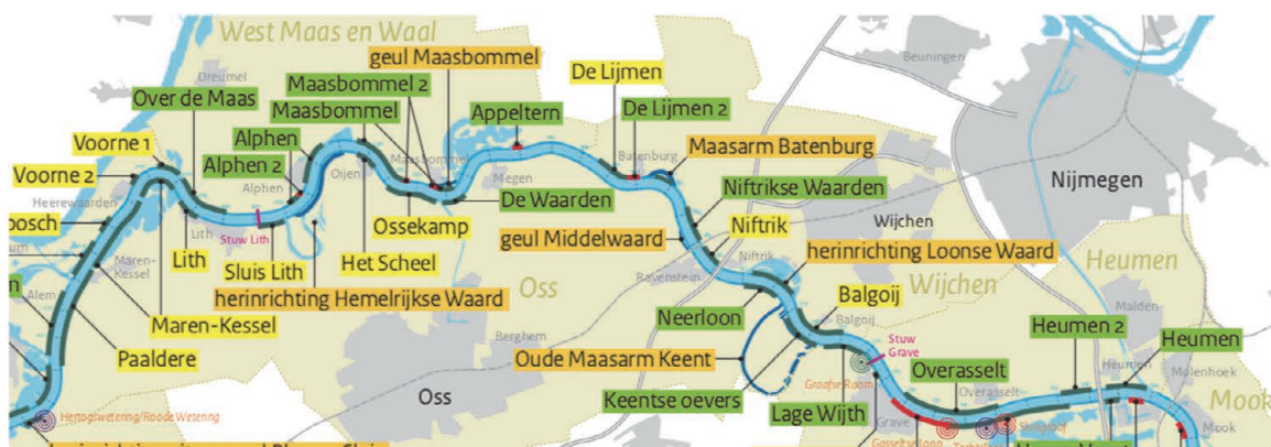
Afbeelding 3. Herinrichting Maasoeveren en uiterwaarden. De laatste werkzaamheden worden in 2018-2019 uitgevoerd. Groen = natuurlijke oevertracings, geel = natuurvriendelijke oevertracings, oranje = uiterwaardprojecten. Groene streep langs de rivier betekent inrichting geroede, rode streep langs de rivier betekent werkzaamheden worden in 2018-2019 uitgevoerd. Bron: Rijkswaterstaat (z.j.).
