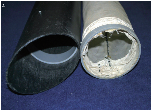
Figuur 6a, b. De gemodificeerde buis van de bladblazer. Boven is de ring in de buis te zien waarachter het netje klem gezet wordt. Rechts is het netje in de buis gemonteerd. Bij het zuigen wordt zo alles opgevangen in het netje. Foto John T. Smit.
