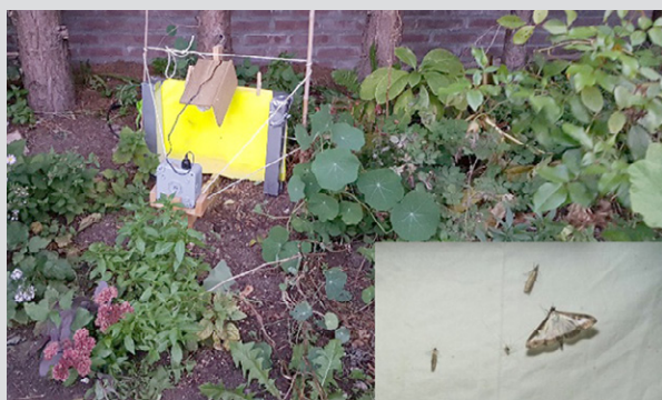
De eerste geïmproviseerde versie van de automatische cameraval (foto Laurens Hogeweg)
